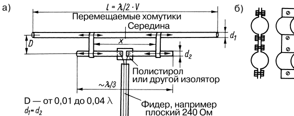
Рис. 6.2. Согласующий Т-трансформатор: а – рекомендуемая компоновка; б – зажимные скобы
