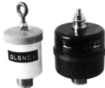
Рис. 6.29. Широкополосные трансформаторы: слева – образец из [24], справа – фирменное изделие
