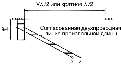
Рис. 10.8. Излучатель с концевым питанием через ненастроенный фидер
