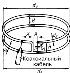
Рис. 19.65. Эскиз модифицированной антенны DDRR (изоляторы-распорки не показаны)
