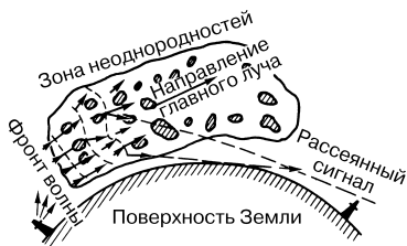
Рис. 2.11. Рассеяние высокочастотных волн в тропосфере
