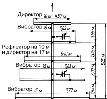
Рис. 18.40. Двухдиапазонная остронаправленная антенна W4KFC с вложенными элементами на 10 и 15 м
