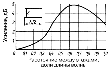
Рис. 13.5. Зависимость максимального усиления двух синфазных вибраторов, расположенных один над другим, от межэтажного промежутка S (по ARRL-Antennen Book)
