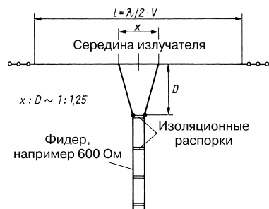
Рис. 6.1. Согласующий дельта-трансформатор
