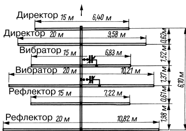
Рис. 18.38. Двухдиапазонная остронаправленная антенна с вложенными элементами на 15 и 20 м
