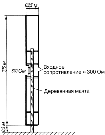
Рис. 19.67. Многодиапазонная вертикальная антенна по принципу T2FD
