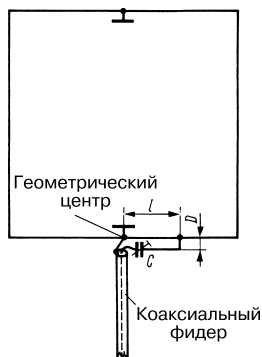
Рис. 15.12. Активный элемент рамочной антенны с гамма-образным согласованием
