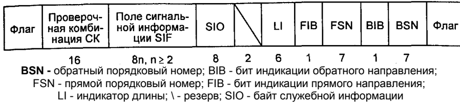
Рис. 10.2. Формат значащей сигнальной единицы MSU
