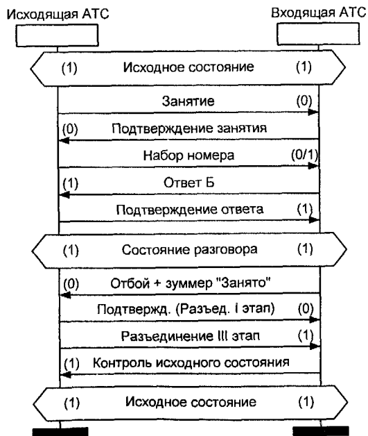
Рис. 7.4. Сценарий обмена сигналами (местный вызов) б) абонент Б свободен, отбой абонента Б
