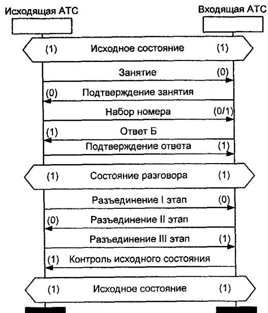
Рис. 7.4. Сценарий обмена сигналами (местный вызов) а) абонент Б свободен, отбой абонента А
