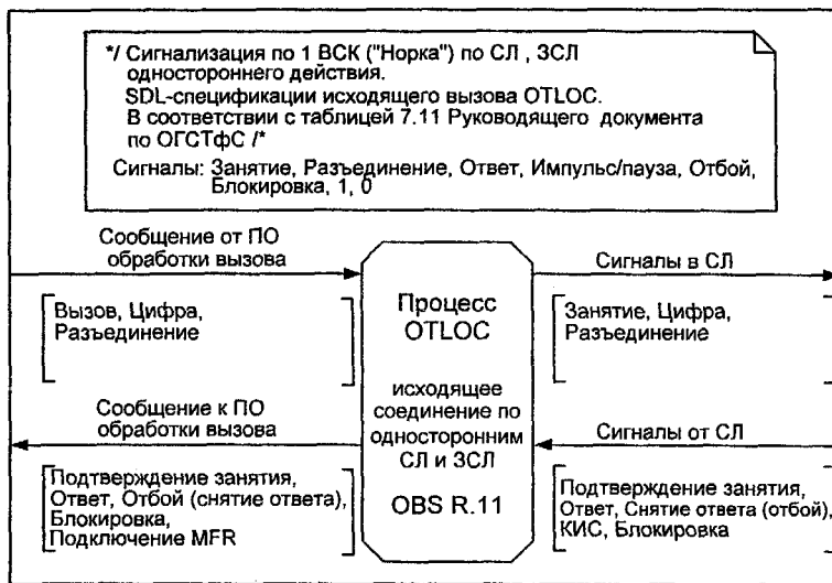
Рис. 7.2. Блок обработки исходящего вызова OTLOC OBS R. 11
